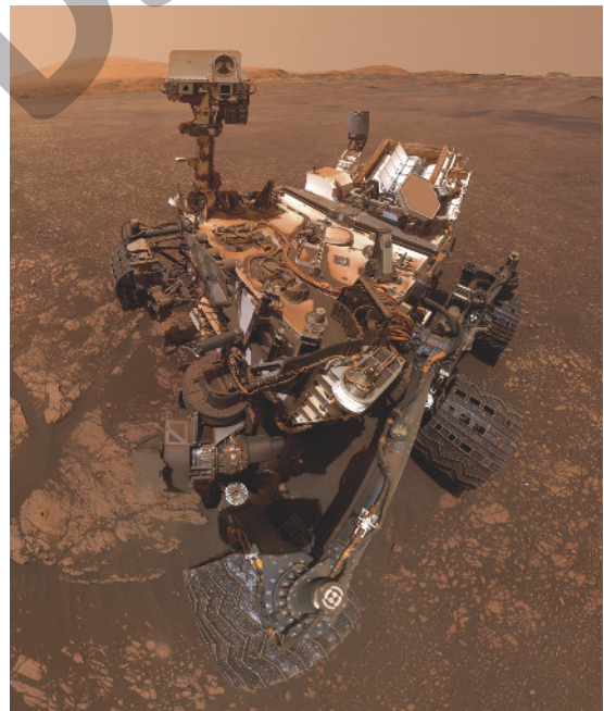
Selfie do rover Curiosity. Imagem de 2019 obtida por uma câmera que fica na extremidade de seu braço robótico.
