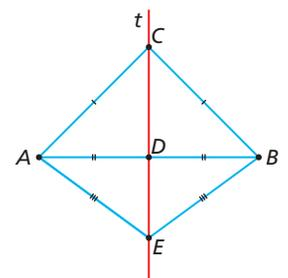
Em uma reflexão, o ponto  $P'$ , imagem de um ponto  $P$  em relação a uma reta, pode ser chamado de **simétrico** do ponto  $P$ . O ponto  $P$ , por sua vez, é o simétrico de  $P'$ . A reta de reflexão também é conhecida como **eixo de reflexão** ou **eixo de simetria**. A simetria em relação a uma reta pode ser chamada de **simetria axial**.
