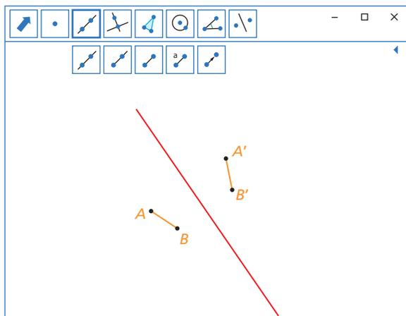
Com a construção geométrica feita acima, podemos perceber que, para determinar o simétrico de um segmento, basta determinar os simétricos das extremidades do segmento e, depois, com as extremidades determinadas, traçar o segmento simétrico.
