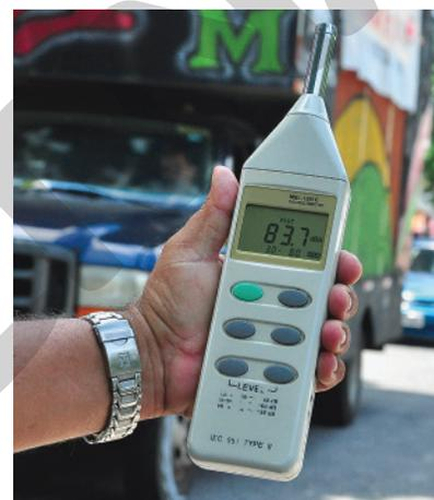
**Figura 6** A medida do nível de intensidade sonora é feita pelo decibelímetro. Nesta foto, o decibelímetro está sendo utilizado para medir o nível de intensidade sonora em uma rua. João Pessoa, PB, 2011.
