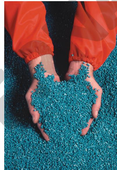
**Figura 14** O *pellet* é o produto final da reciclagem mecânica do plástico.
