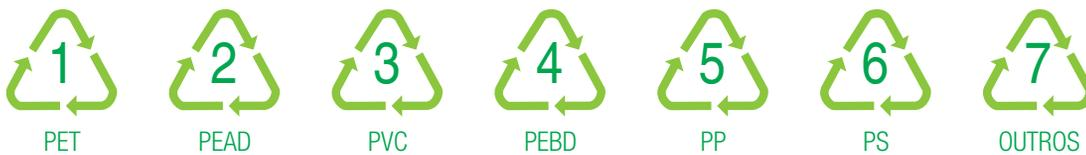
**Figura 13** Símbolos identificadores de plásticos recicláveis: 1. Politereftalato de etila (PET); 2. Polietileno de alta densidade (PEAD); 3. Policloreto de vinila (PVC); 4. Polietileno de baixa densidade (PEBD); 5. Polipropileno (PP); 6. Poliestireno (PS); 7. Outras resinas, como acrilonitrila-butadieno-estireno (ABS).
