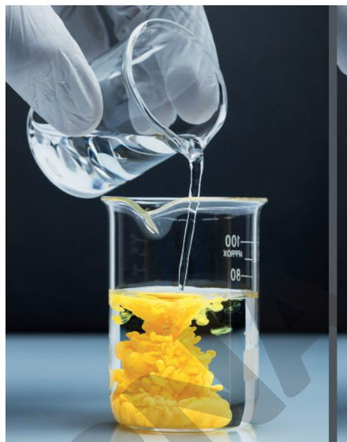
O precipitado amarelo de iodeto de chumbo(II) ( $PbI_2$ ) é o produto da reação entre os íons  $Pb^{2+}$  (aq) e  $I^-$  (aq). Aos poucos, ele vai decantando e se deposita no fundo do recipiente.
