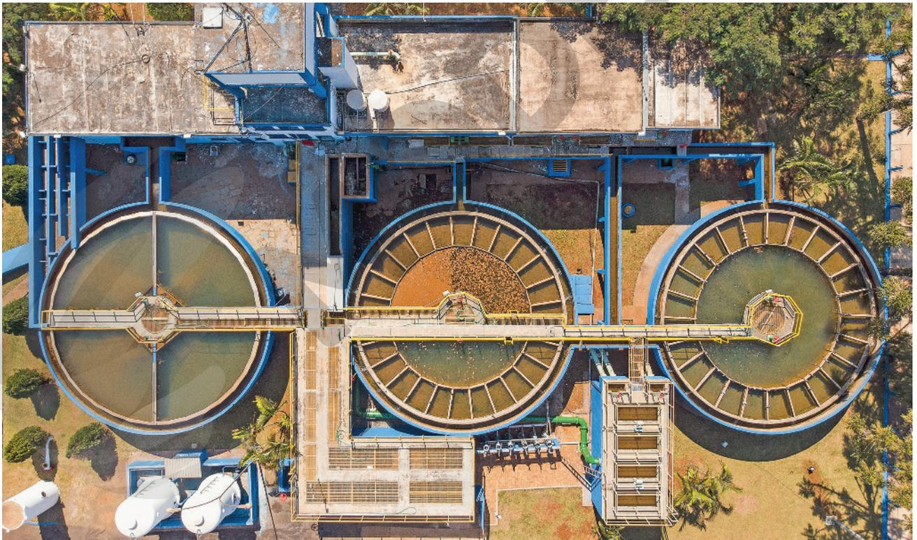
Tanque de decantação em estação de tratamento de água em Cornélio Procópio (PR), 2018. Nesses tanques, a sujeira (por exemplo, pequenas partículas sólidas) que está dispersa na água decanta no fundo do recipiente.
