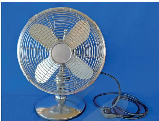
Ventilador comum de hélices de 127 V-120 W. A potência nominal do ventilador é de 120 W. Isso significa que ele consome 120 J de energia elétrica a cada segundo de funcionamento. No entanto, a potência que o equipamento efetivamente pratica é menor do que 120 W, visto que aquecerá ao funcionar e dispersará energia térmica para o ambiente.
