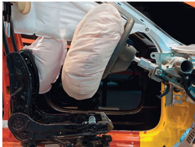
*Airbag* inflado, graças à formação de  $N_2(g)$ , após redução abrupta da velocidade do veículo.
