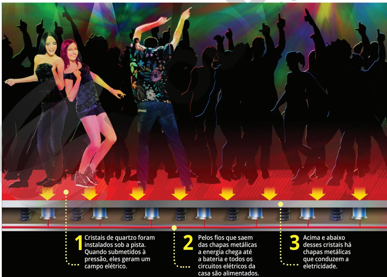
**1** Cristais de quartzo foram instalados sob a pista. Quando submetidos à pressão, eles geram um campo elétrico.
