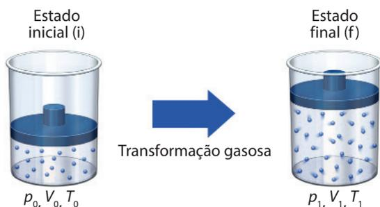
Para estudarmos a mudança de estado termodinâmico de um gás, cuja massa permanece fixa, realizamos uma transformação gasosa. Experimentalmente, verifica-se a ocorrência de transformações gasosas na massa de determinado gás à pressão  $p_0$ , ocupando volume  $V_0$  e à temperatura  $T_0$ , quando ocorre um processo termodinâmico capaz de conduzi-lo a ocupar um volume  $V_1$ , deixando-o com pressão  $p_1$  e temperatura  $T_1$ , sem que ocorra perda de sua massa.
