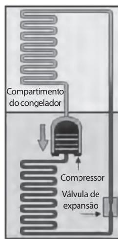
Ilustração dos componentes necessários para o funcionamento da geladeira.
