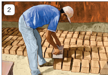
2 EM SEGUIDA, ELA É RETIRADA DAS FÔRMAS E COLOCADA PARA SECAR.
