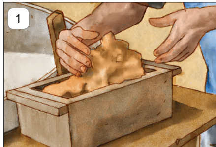
1 A ARGILA, AINDA MALEÁVEL, É COLOCADA EM FÔRMAS COM FORMATO DE TIJOLO.
