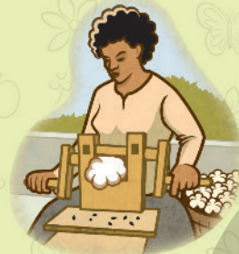
O artesão retirava as sementes do algodão com o auxílio do descaroçador, um aparelho movido por manivelas.
