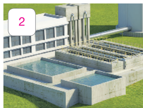
A água passa por um processo de filtração, eliminando partículas menores que ainda estejam presentes.
