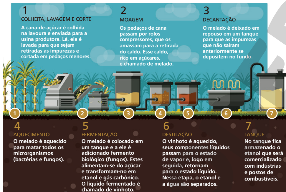
Representação esquemática das etapas da produção do etanol de cana-de-açúcar. (Imagem sem escala; cores fantasia.)
