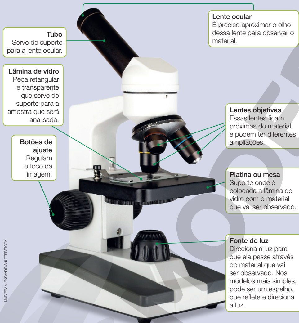
Modelo simples de microscópio óptico.
