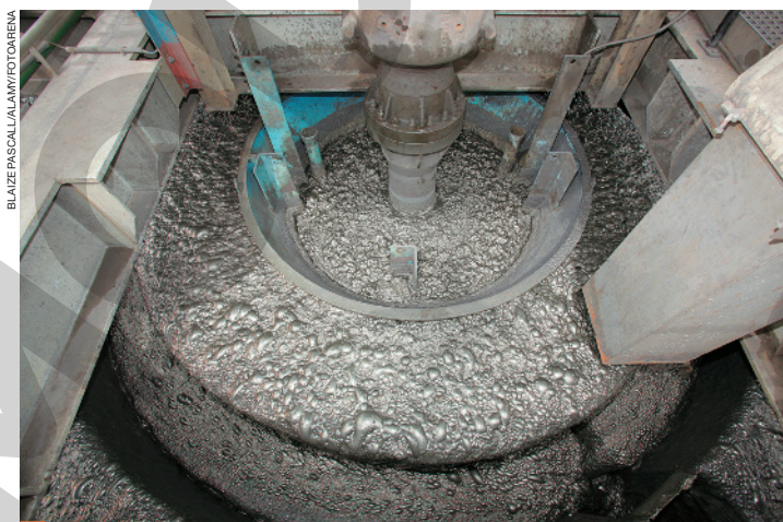
Processo de flotação em uma indústria de papel na África, em 2017.
