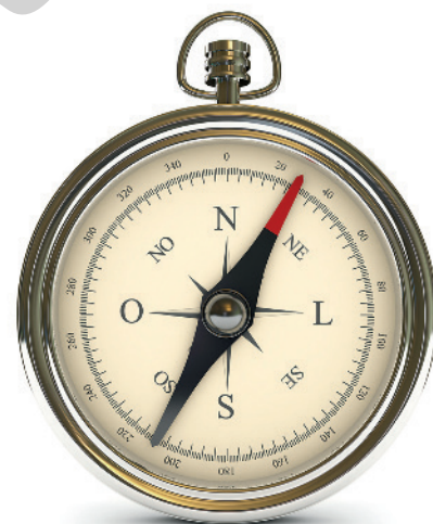
Bússola. A parte pintada da agulha indica, aproximadamente, a direção norte.
