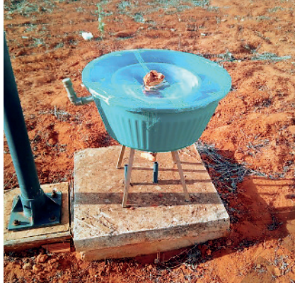
Protótipo criado por estudantes do Colégio Estadual Quilombola de São Tomé, na Bahia, para transformar a água salgada em potável. Campo Formoso (BA), 2019.
