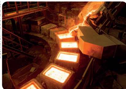
Metal líquido sendo colocado em moldes retangulares.
