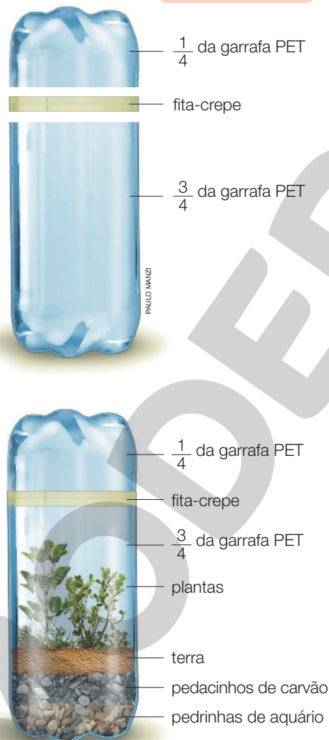
Representação esquemática da montagem da atividade. (Imagem sem escala; cores fantasia.)
