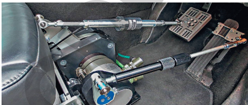
Robô de pedais utilizado em testes de freio e controle de velocidade de automóveis.
