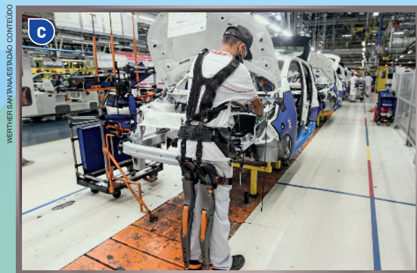
Trabalhador utilizando exoesqueleto em indústria no município de Betim, no estado de Minas Gerais, em 2018.
