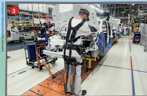
Profissional utilizando exoesqueleto em indústria automobilística no município de Betim, no estado de Minas Gerais, em 2018.
