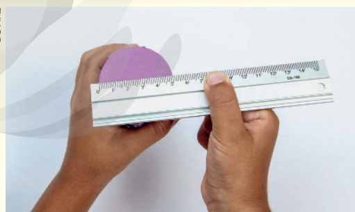
Régua posicionada para medir o diâmetro de um cilindro.
