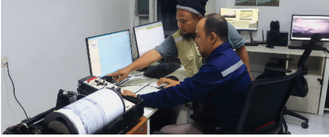
Sismógrafo, aparelho utilizado por cientistas para monitorar a ocorrência de terremotos e para auxiliar na previsão de erupções vulcânicas.
