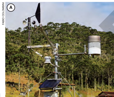
(A) Exemplo de estação meteorológica automatizada (Cunha, SP, 2017). Os sensores são programados para atualizar e enviar os dados para uma central em intervalos regulares de tempo. (B) Embora funcionem de forma autônoma, os sensores precisam ser rotineiramente inspecionados para garantir a precisão dos dados coletados (China, 2022).
