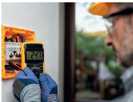
O multímetro é um aparelho destinado a medir grandezas associadas à eletricidade.
