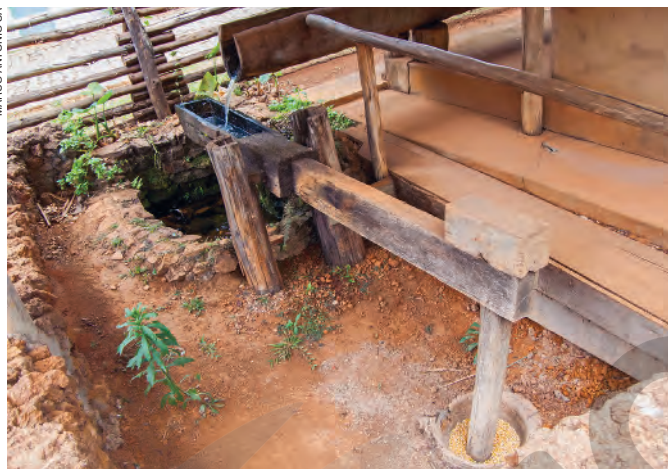
O monjolo é uma máquina que utiliza energia hidráulica para seu funcionamento. Uma de suas funções é socar e triturar grãos. (Goiânia, GO, 2013.)
