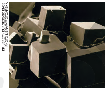
Cristais de cloreto de sódio vistos com microscópio eletrônico de varredura. (Imagem colorizada artificialmente e ampliada cerca de 180 vezes.)
