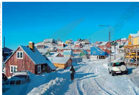
Pessoa caminha em região polar na Groenlândia (2020). Note que os telhados das construções são inclinados, para evitar o acúmulo de neve.
