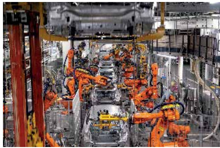
Robôs montam carroceria de carros em Munique, Alemanha (2021).
