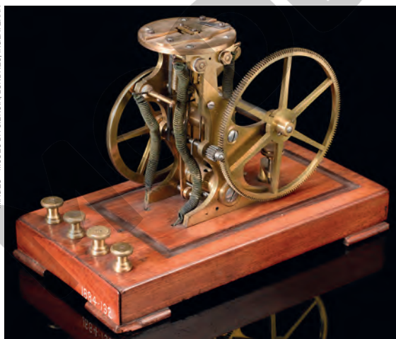
Telégrafo criado pelo britânico Charles Wheatstone em 1838. Museu da Ciência, Londres, Inglaterra.
