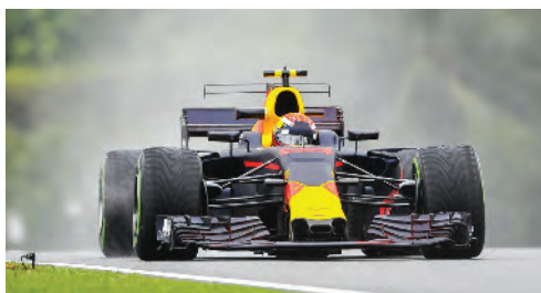
Esse veículo deve atingir altas velocidades e, por isso, seu formato é projetado para que a resistência do ar sobre ele seja baixa. Dizemos que ele possui uma forma aerodinâmica .
