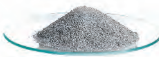
A substância ferro, sólido cinza-metálico com TF = 1 538 °C, TE = 2 861 °C, d = 7,87 g/mL.
