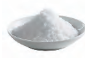
A substância cloreto de sódio, sólido branco com TF = 801 °C, TE = 1 465 °C, d = 2,17 g/mL.
