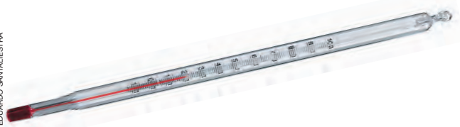
Termômetro de álcool colorido de vermelho. Álcool colorido de azul também é usado, às vezes.
