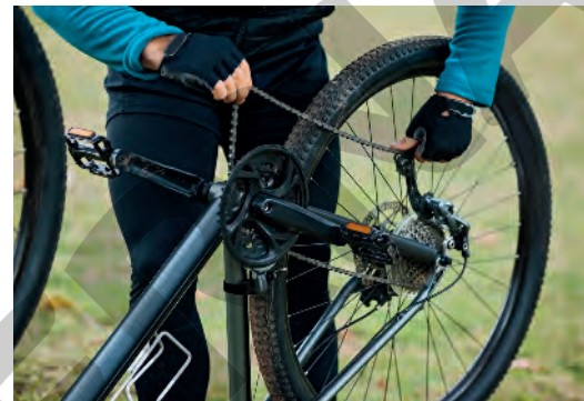
Na bicicleta com marchas, temos um exemplo da utilização de rodas dentadas de diferentes tamanhos e corrente.
