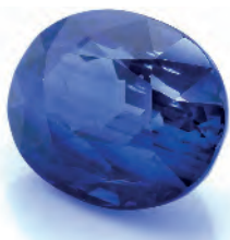
A safira é constituída principalmente de Al_2O_3 , uma substância iônica incolor. A cor se deve à pequena quantidade de "impurezas" presentes.
