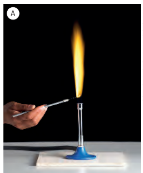
Teste da chama com o elemento sódio.
