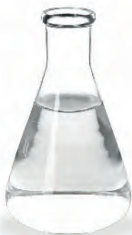
A substância água, líquido incolor com TF = 0 °C, TE = 100 °C, d = 1,0 g/cm 3 .
