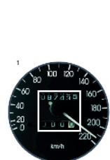
Hodômetro: aparelho usado para medir distância percorrida.
