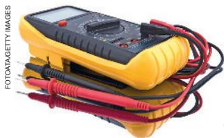
Amperímetro é um instrumento usado para medir a corrente elétrica.
