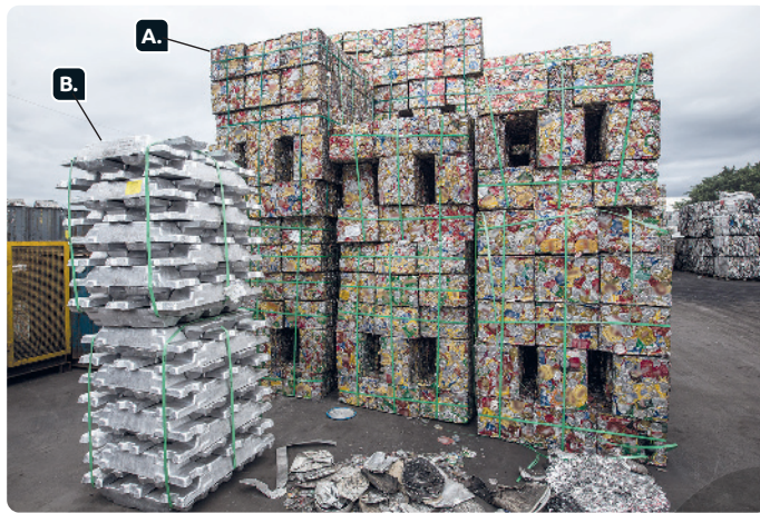
Latas de alumínio prensadas (A) e lingotes de alumínio (B) em usina de reciclagem no município de Pindamonhangaba, SP, em 2018.
