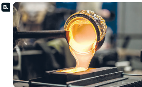
Vidro fundido sendo colocado em molde em uma indústria.
