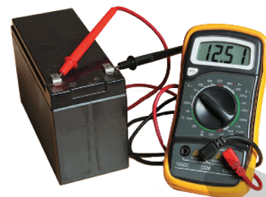
Voltímetro conectado a uma bateria de motocicleta, registrando uma diferença de potencial de 12,51 V.
