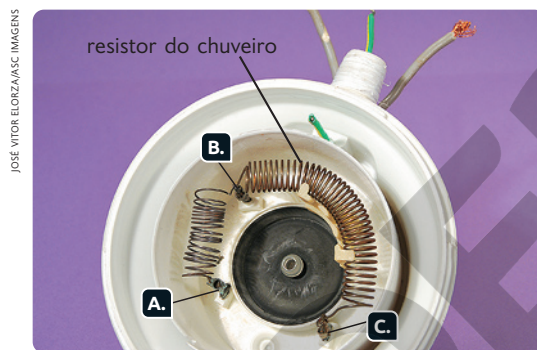
Parte interna de um chuveiro elétrico com destaque para o resistor.
