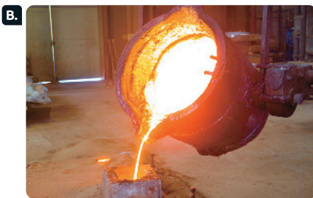
Ferro no estado físico líquido, sendo despejado em uma forma.
