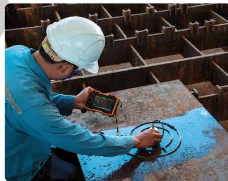
Trabalhador utilizando ultrassom em uma placa de metal para identificar possíveis imperfeições.
