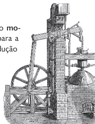
Representação da máquina a vapor inventada por James Watt, de autor desconhecido. Gravura, século XIX.
