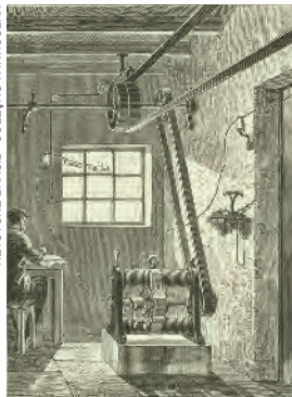
Representação de dínamo utilizado para gerar luz elétrica em uma residência na França, desenvolvido pelo engenheiro Marcel Deprez, em gravura de c. 1880.
